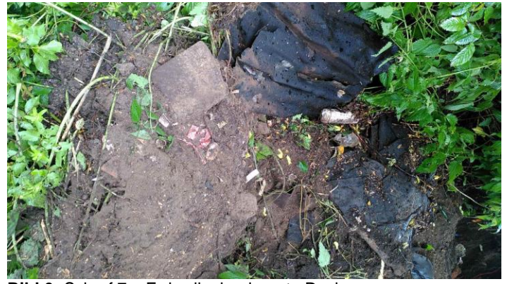
Bild 6: Schurf 7 – Erdwall, abgelagerte Dachpappen
